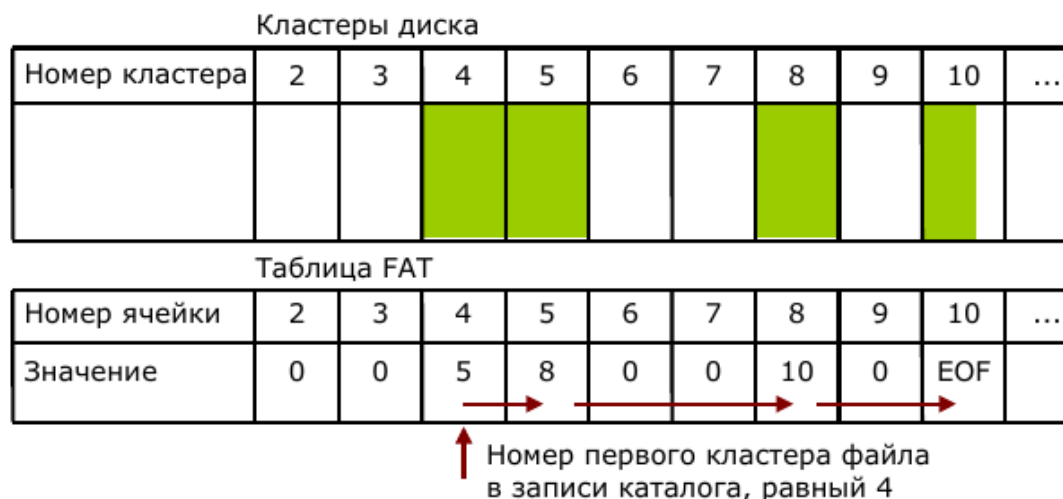
Рисунок 3 – Соответствие записей в FAT и содержимого кластеров
