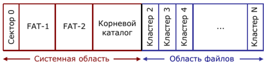
Рисунок 2 – Физическая структура файловой системы FAT
