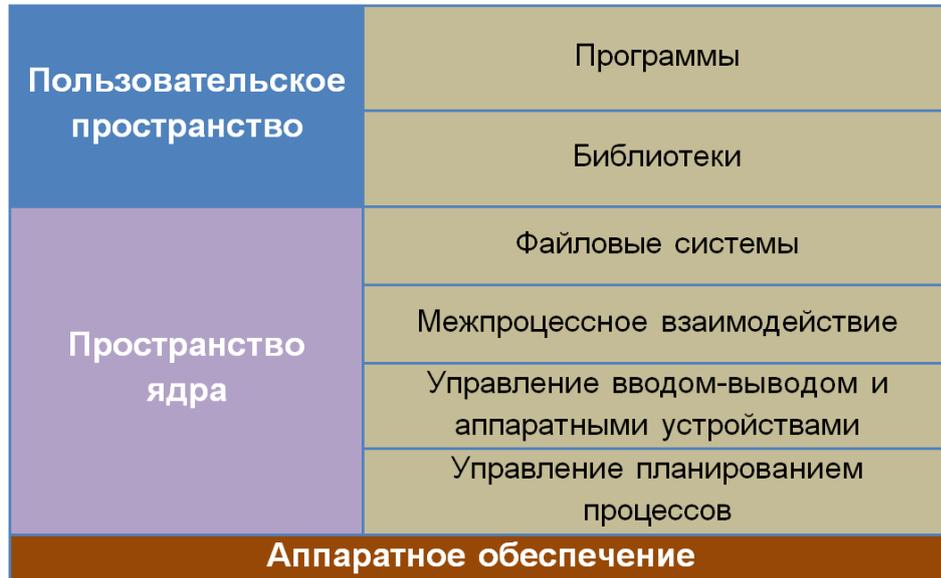
Рисунок 3 – ОС на основе монолитного ядра
