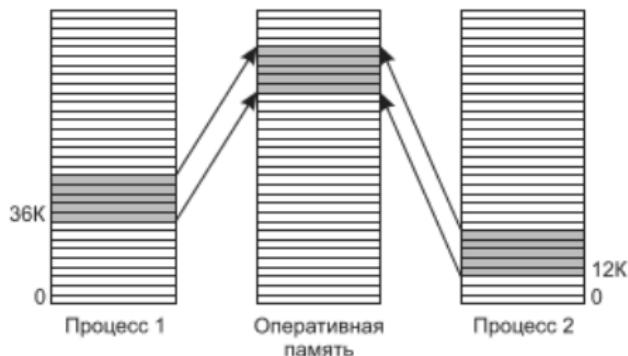
Совместно используемые библиотеки могут быть размещены на СИС, однако в разных процессах им не удается обеспечить одинаковые виртуальные адреса (проблема перемещения).
