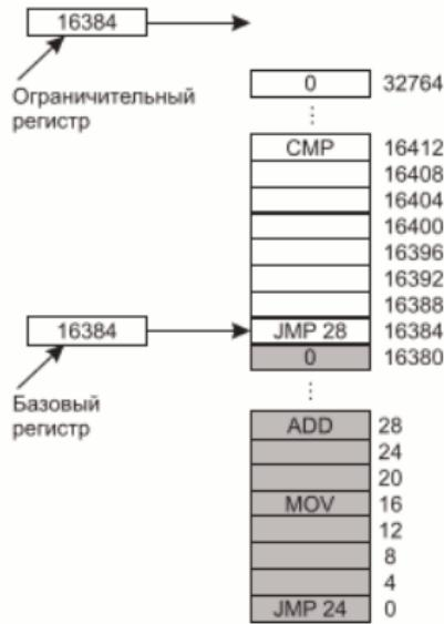
При каждой ссылке процесса на память ЦП перед выставлением адреса на шине памяти добавляет к адресу, сгенерированному процессом, значение базового регистра. Также проверяется значение ограничительного регистра.
