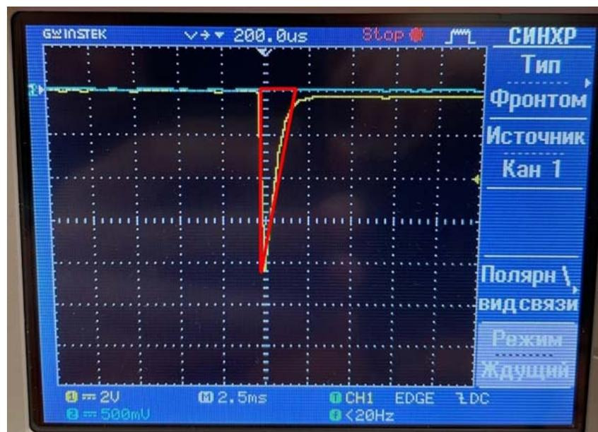
Рис. 7 – Вычисление перенесенного заряда в случае разрыва цепи между Arduino и БП.
