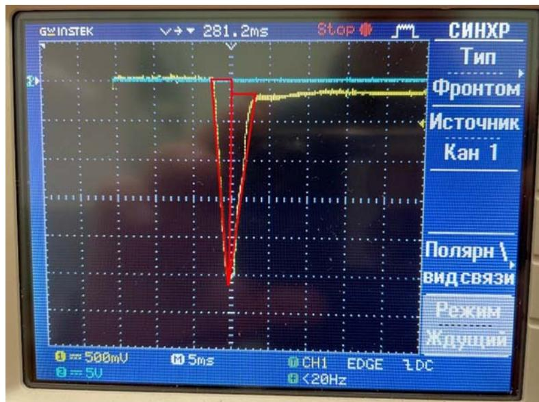
Рис. 8. Вычисление перенесенного заряда в случае разрыва цепи между БП и сетью.
