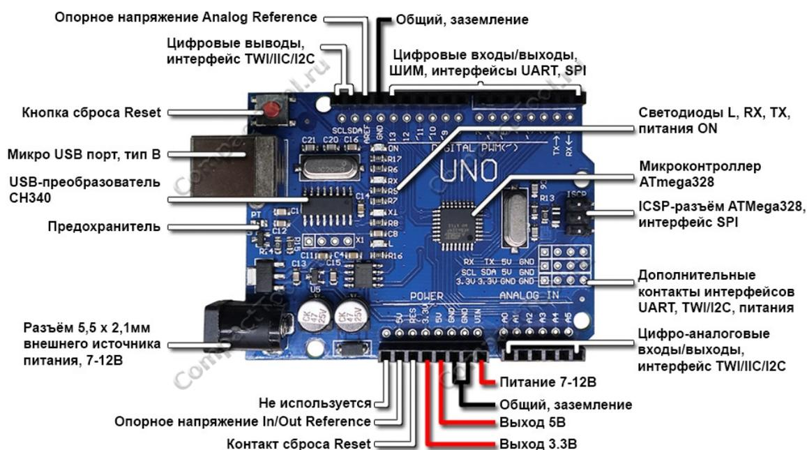
Существенной разницы между этими микроконтроллерами нет, так что возможна взаимозаменяемость. Однако, Atmega328P-PU потребляет меньше энергии и является более мощным, чем Atmega328P-AU. Это означает, что для Atmega328P-PU использовался более точный техпроцесс (60 нм у ATmega328P-PU - против 90 нм у ATmega328P-AU), поэтому обычно эти чипы дороже.
