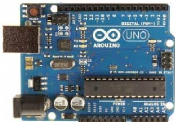
Arduino Uno R3 в корпусе PDIP28 (Atmega328P-PU)
