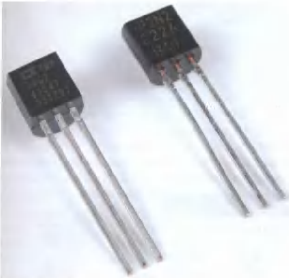
Рис. 7.2. Датчик температуры TMP36 (слева) и транзистор 2N2222 (справа)
