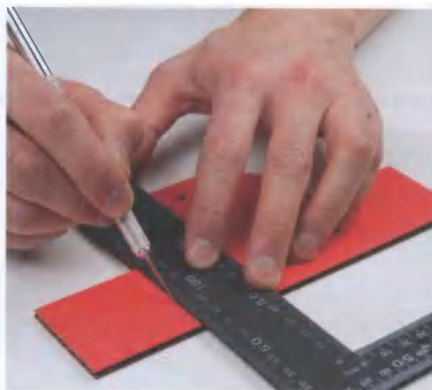
Рис. 6.25. Надрезание боковых стоек
