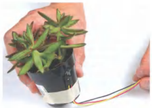
Рис. 7.36. Прикрепляем термодатчик непосредственно к горшочку с растением
