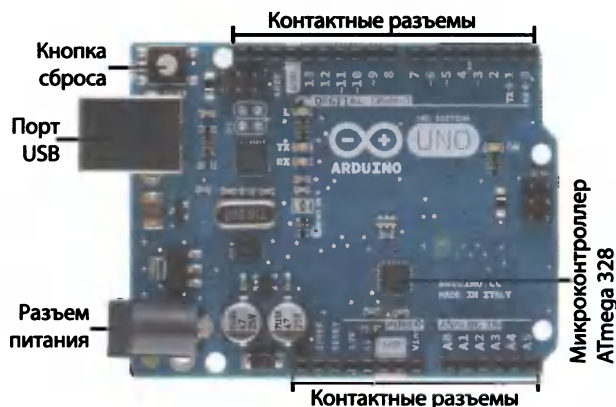
Рис. 1.2. Arduino Uno — открытая программируемая платформа для любителей электроники
