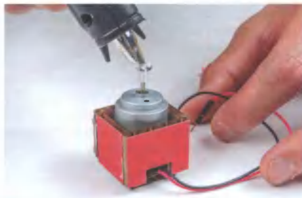
Рис. 7.33. Наносим клей на вал электродвигателя
