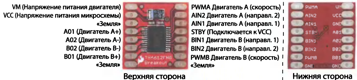
Рис. 8.6. Адаптерная плата с микросхемой TB6612FNG Н-мостового драйвера электродвигателя (без впаянных штыревых разъемов)
