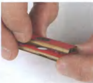
Рис. 8.14. Усиление жесткости держателя фломастера: нанесение клея на фрагменты держателя ( слева ), склеивание фрагментов ( посередине ) и приклеивание держателя к платформе ( справа )
