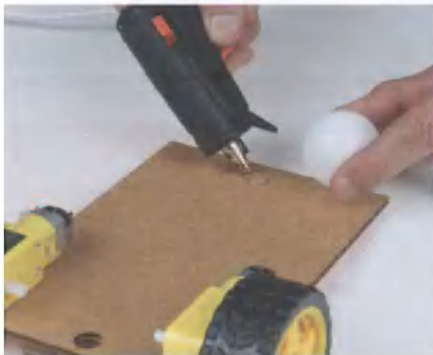
Рис. 8.16. Приклеиваем опору из теннисного мячика
