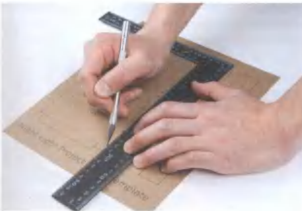
Рис. 5.21. Вырезание корпуса из открыточного картона
