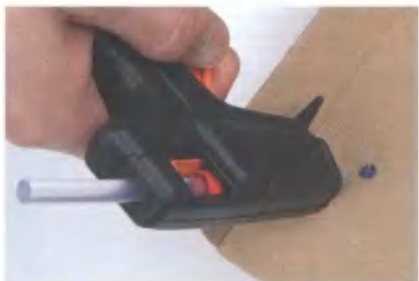
Рис. 4.18. Закрепление в корпусе светодиодов с помощью клеевого пистолета
