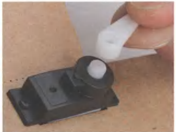
Рис. 6.29. Надеваем одностороннюю качалку на вал сервомашинки
