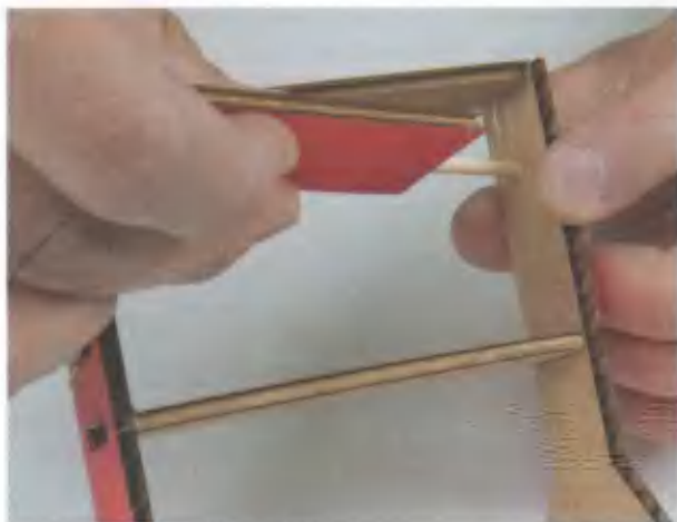
Рис. 9.21. Вставляем ось ворот в боковую стойку башни
