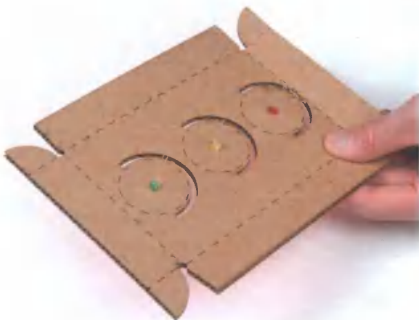
Рис. 2.18. Светодиоды, вставленные в заготовку корпуса модели светофора
