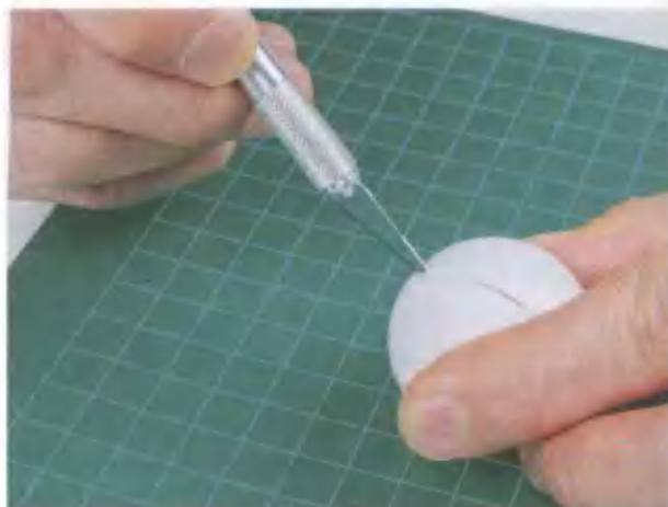
Рис. 2.22. Безопасный способ разрезки мячика для настольного тенниса
