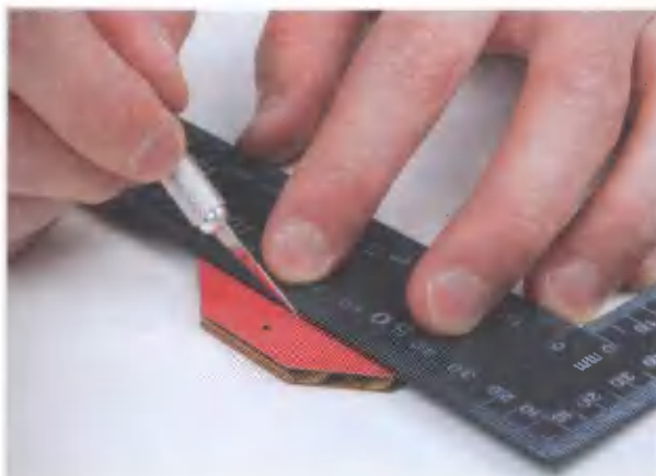
Рис. 6.19. Подготавливаем крепление для тяги: делаем надрез (слева) и сгибаем по надрезу (справа)
