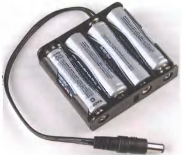
Рис. 2.12. Держатель на 4 батарейки AA с цилиндрическим разъемом
