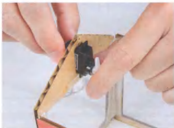
Рис. 7.23. Установка сервомашинки в стенку теплички
