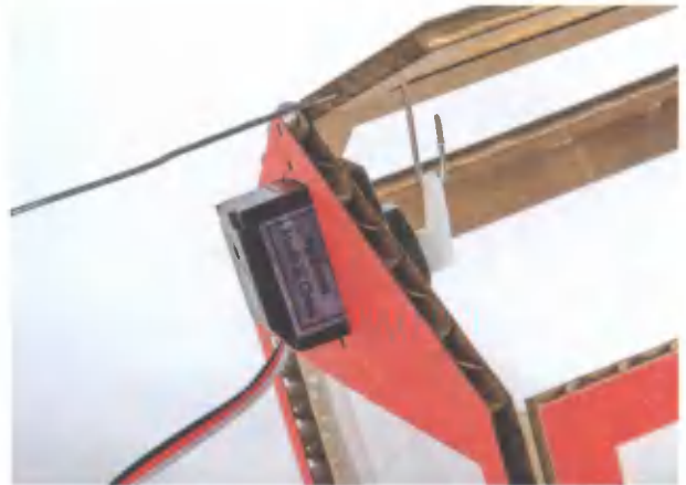
Рис. 7.28. Тяга качалки сервомашинки, подсоединенная к окну
