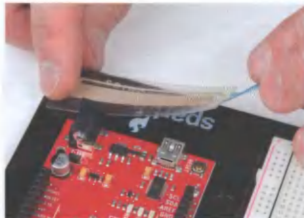
Рис. 10.12. Приклеиваем мембранный потенциометр к держателю платы Arduino ( слева ) или к кусочку картона ( справа )
