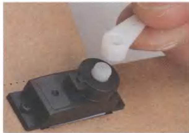
Рис. 6.14. Надевание односторонней качалки на шпиндель сервомашинки
