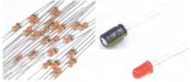
Рис. 9. Примеры дискретных компонентов: резисторы (слева), конденсатор (посередине) и светодиод (справа)
