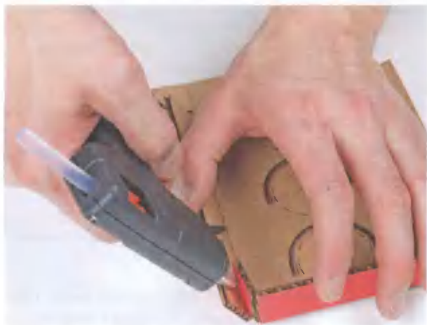
Рис. 2.21. Гибка и склейка картонного корпуса модели светофора
