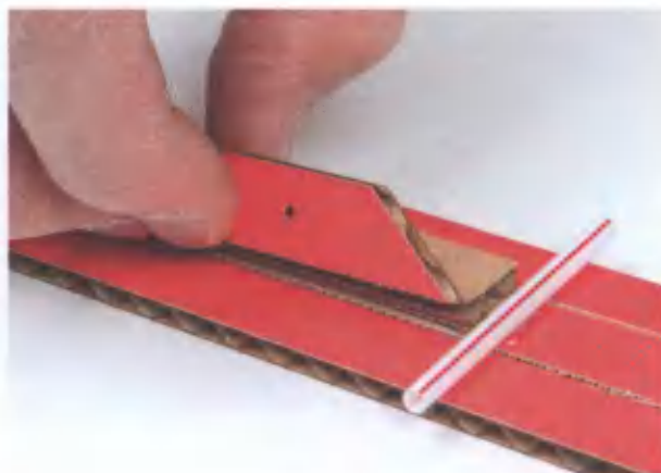
Рис. 6.21. Приклеивание к балке крепления для тяги
