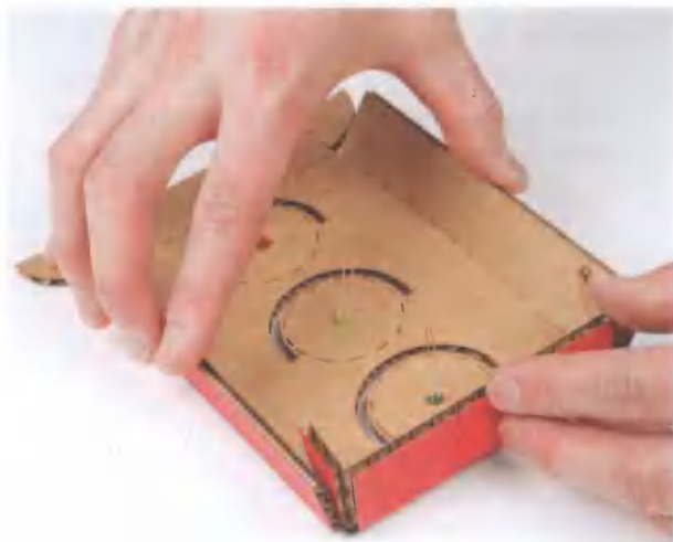
Рис. 2.20. Сгибание сторон корпуса светофора по надрезанным линиям
