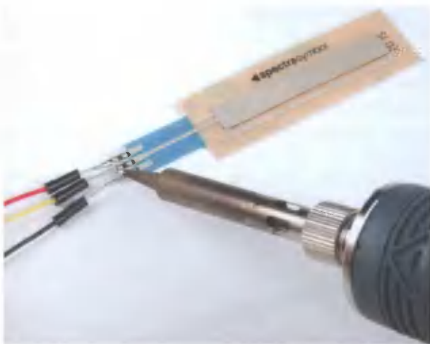
Рис. 10.11. Припаиваем перемычки к выводам мембранного потенциометра
