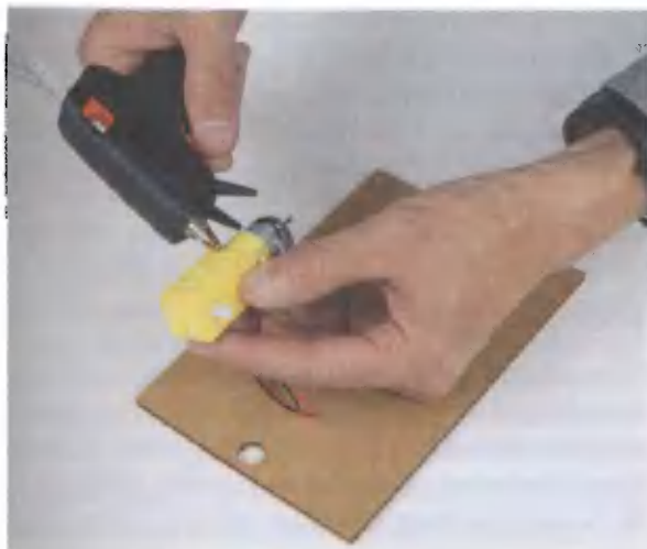
Рис. 8.13. Прикрепляем электродвигатели к платформе: нанесение клея ( слева ) и ориентация относительно платформы ( справа )
