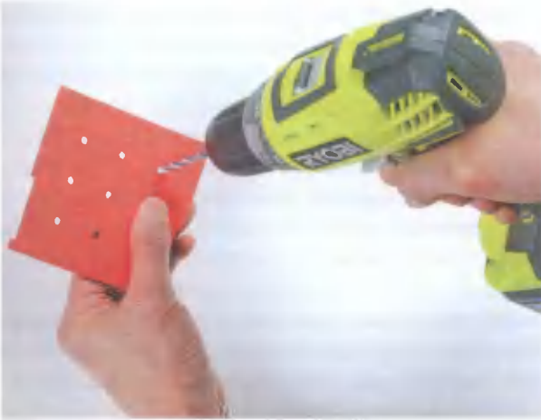
Рис. 3.14. Сверление отверстий под светодиоды. Будьте осторожны при сверлении или обратитесь к взрослым за помощью
