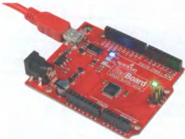
Рис. 1.19. Исполнение скетча: мигание светодиода 13
