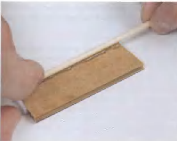
Рис. 9.20. Приклеиваем ось к створке стартовых ворот ( слева ), совмещая ее со ступицей ( справа )
