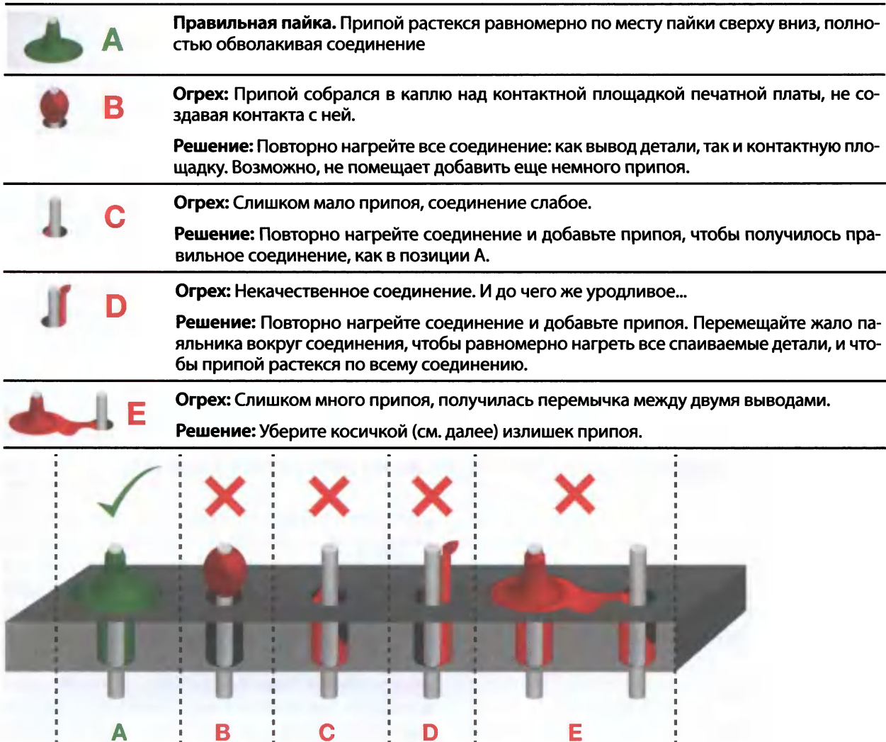
Рис. П.11. Правильное паяное соединение и наиболее распространенные огрехи пайки и способы их устранения
