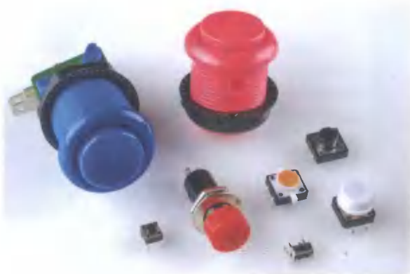
Рис. 4.4. Несколько примеров кнопок
