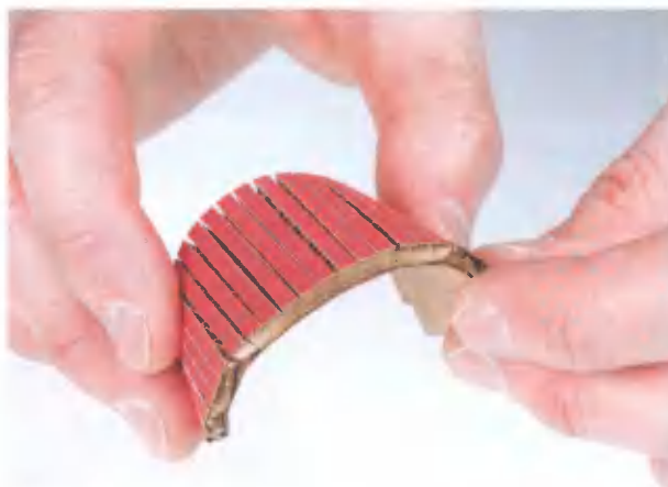
Рис. 2.25. Сгибание затенителя в дугу
