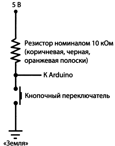
Рис. 4.7. Схема подключения кнопки к Arduino с использованием нагрузочного резистора
