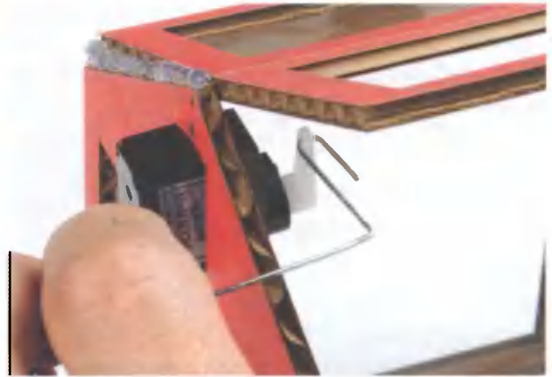
Рис. 7.27. Взаимное расположение окна, качалки сервомашинки и тяги
