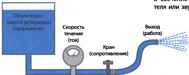
Рис. 2. Модель электрического тока: вода в трубе
