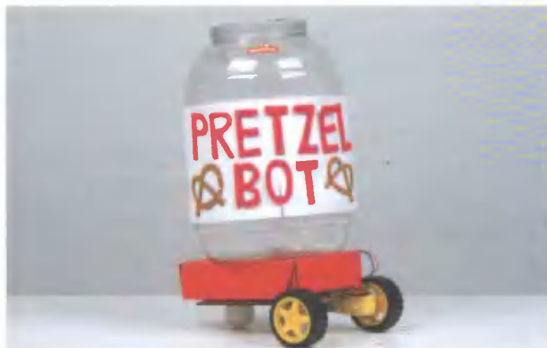
Рис. 8.20. Крендель-Бот: плата Arduino и макетная плата скрыты внутри красной коробки
