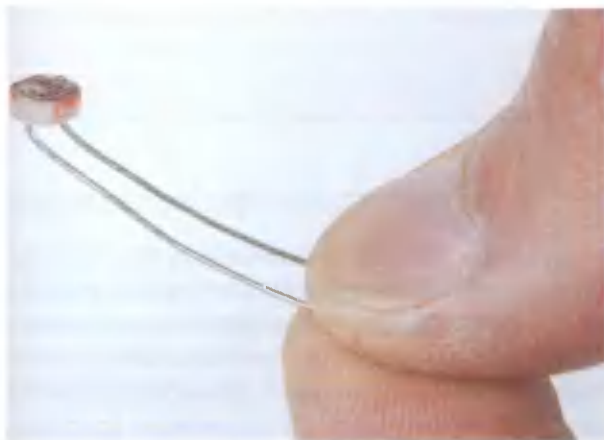
Рис. 9.24. Изгибаем выводы фоторезистора под прямым углом
