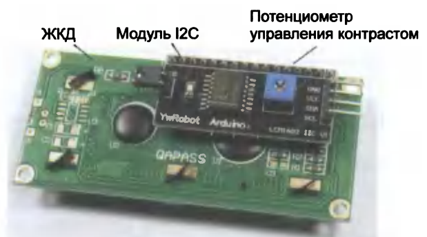
Рис. 9.30. Плата ЖКД 1602 с модулем I2C
