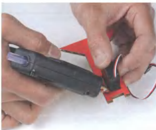
Рис. 9.17. Закрепляем сервомашинку с помощью клеевого пистолета
