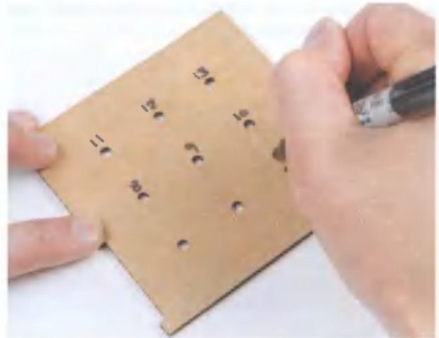
Рис. 3.16. Нумерация отверстий светодиодной матрицы
