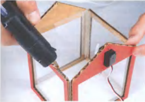
Рис. 7.26. Приклеиваем одну сторону крыши, оставляя другую свободной, чтобы она могла открываться и закрываться
