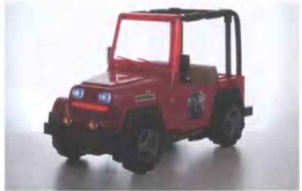
Рис. 1.24. Масштабная модель автомобиля с фарами, управляемыми Arduino
