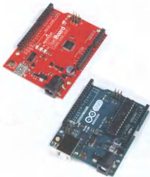
Рис. 12. Микроконтроллерная плата RedBoard компании SparkFun (вверху слева) и плата Arduino Uno (внизу справа)
