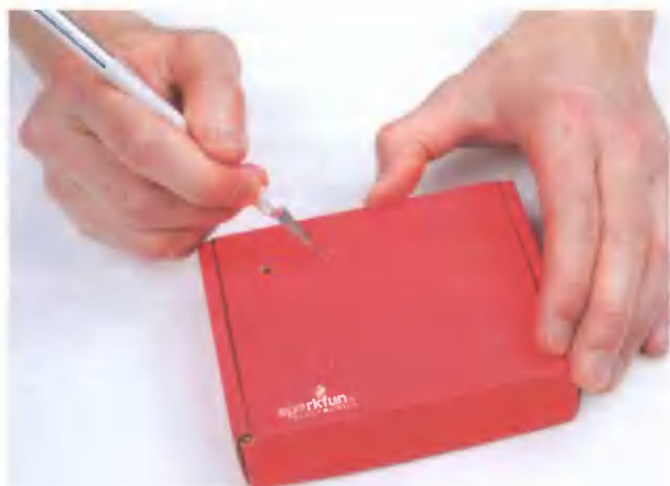
Рис. 4.17. Вырезание отверстий в корпусе с помощью макетного ножа
