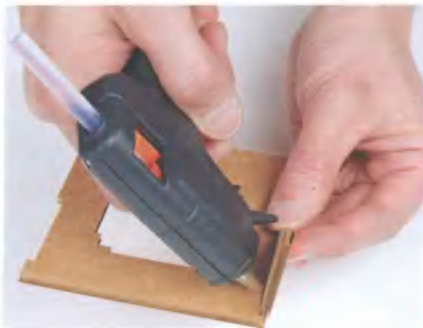
Рис. 3.19. Приклеивание треугольников жесткости к основанию
