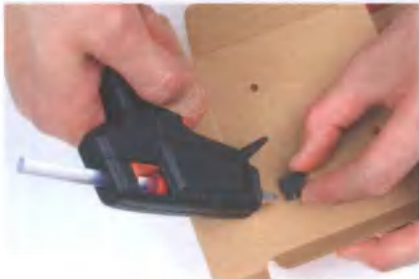
Рис. 4.19. Закрепление в корпусе кнопки с помощью клеевого пистолета
