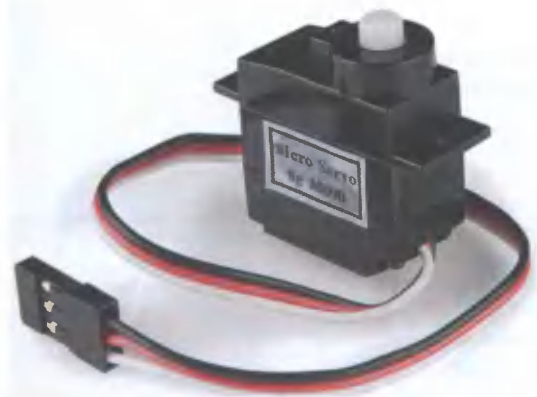
Рис. 6.8. Стандартная сервомашинка для моделирования
