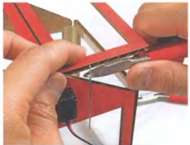
Рис. 7.29. Закрепляем тягу и откусываем лишнюю длину
