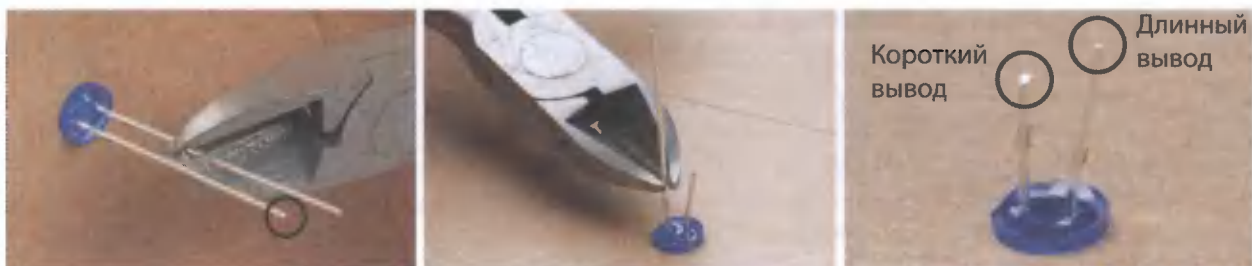
Рис. 4.20. Укорачивание выводов светодиодов с сохранением их относительной длины
