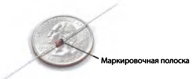
Рис. 7.17. Диод обратного хода тока для защиты транзистора, показанный с четвертаком 1 для сравнения размеров
