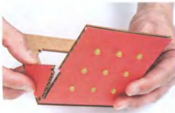
Рис. 3.18. Ориентация треугольников жесткости при установке лицевой панели на основание
