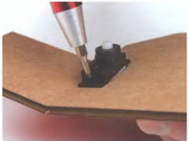
Рис. 6.28. Крепим сервомашинку к боковой стойке
