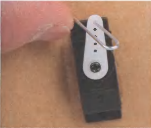
Рис. 6.35. Вставляем тягу в качалку сервомашинки: согнутый конец тяги (слева) пройдет в последнее отверстие в качалке (справа)
