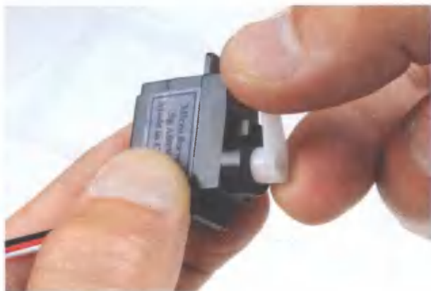
Рис. 7.22. Установка качалки на вал в позиции 180 градусов
