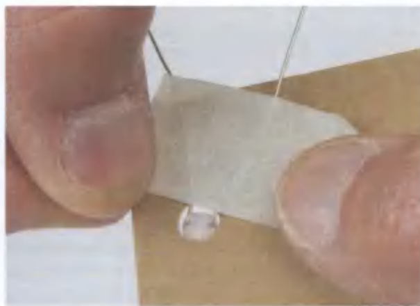
Рис. 9.25. Прикрепляем фоторезистор к гоночной трассе
