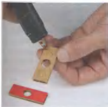
Рис. 8.14. Усиление жесткости держателя фломастера: нанесение клея на фрагменты держателя ( слева ), склеивание фрагментов ( посередине ) и приклеивание держателя к платформе ( справа )
