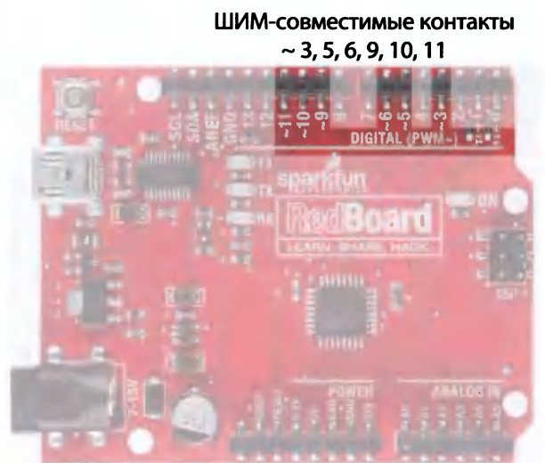
Рис. 5.18. Выводы ШИМ платы RedBoard
