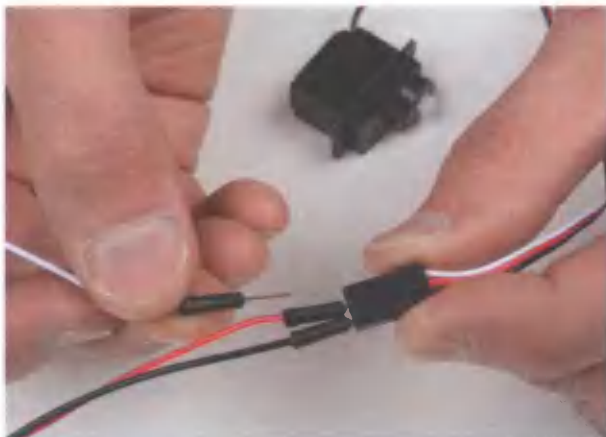
Рис. 6.12. Подключение проволочных перемычек к разъему сервомашинки
