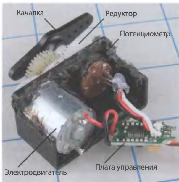
Рис. 6.9. Внутреннее устройство сервомашинки
