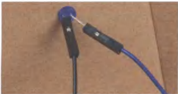
Рис. 4.21. Подключение к светодиодам гнездового конца проволочных перемычек
