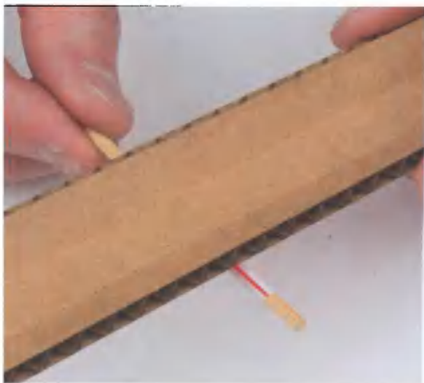
Рис. 6.24. Ось качения из бамбуковой палочки: длина выступающих частей оси одинаковая с обеих сторон
