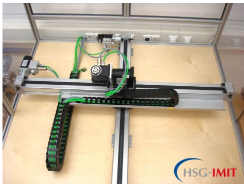
Двухосевой стол для калибровки линейных ускорений
