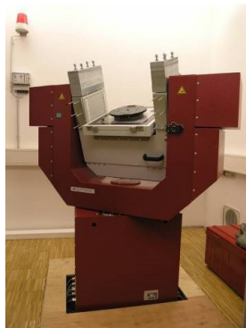
Стенд для калибровки вращений по трём осям с температурной камерой
